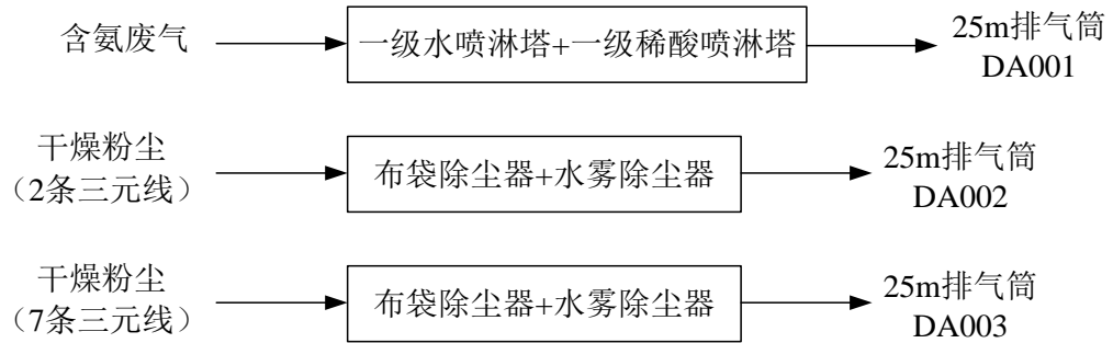
图 3.2-11 2 万吨三元车间废气处理设施示意图
